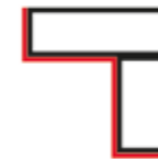
L-Form Längskantenfräsung - L2-L
