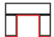
U-Form Längskanten- / Stirnkantenfräsung - U3-LS
